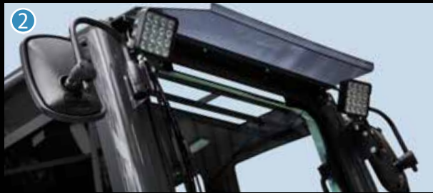
② Luces delanteras LED (opcionales), visera antilluvia (opcional) y espejos retrovisores (izquierdo y derecho)
