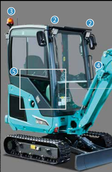
② Luces delanteras LED (opcionales), visera antilluvia (opcional) y espejos retrovisores (izquierdo y derecho)
