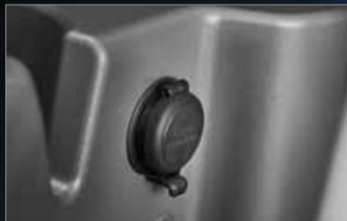
Alimentación eléctrica de 12 V
