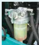
Voorfilter met ingebouwde waterafscheider
