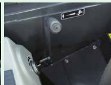
Schakelaar voor hoge/lage rijsnelheid en gashendel
