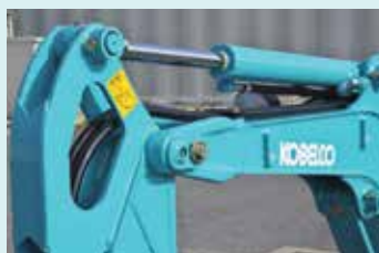
Slangen bakcilinder lopen door graafarm
