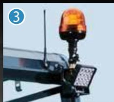
LED-Rücklicht, abnehmbare orangefarbene LED-Rundumleuchte (optional)
