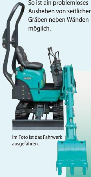
Im Foto ist das Fahrwerk ausgefahren.
