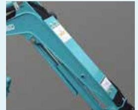
Schlauchschutzabdeckung auf der Rückseite des Auslegers
