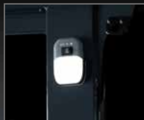
Éclairage de cabine à LED
