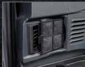
Filtre à air intérieur de climatisation
