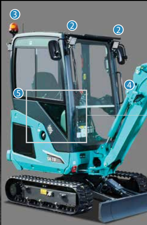
Phares avant à LED, visière pare-pluie et rétroviseurs (gauche et droit)
