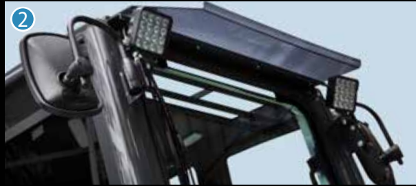
Phares avant à LED, visière pare-pluie et rétroviseurs (gauche et droit)
