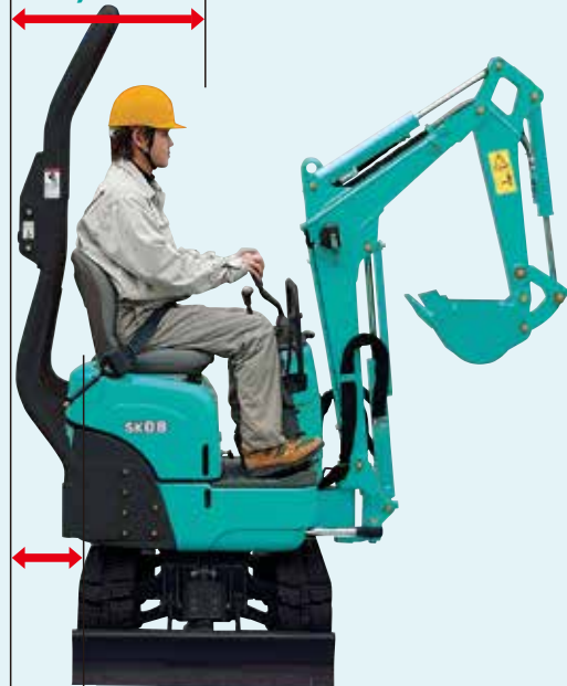
SK08 en position châssis élargi et déport droit maximum.
